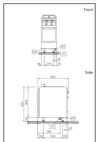
Electrical inlet (power) Equipotential screw
